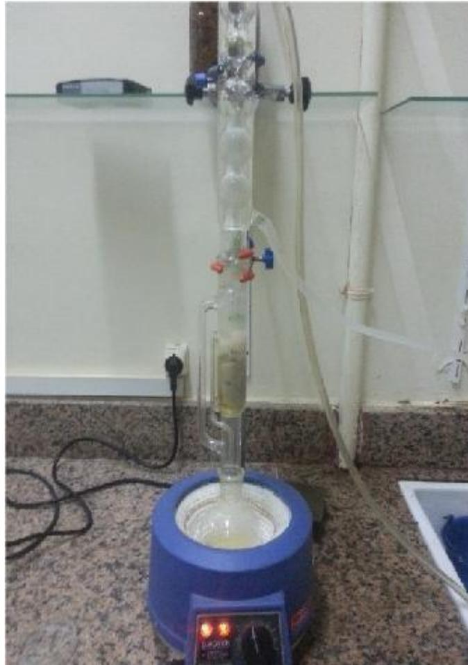
**Figure 11** : Image photographique de l'appareil de Soxhlet
